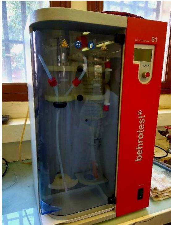
*Figure 43 Distillateur behro test*
