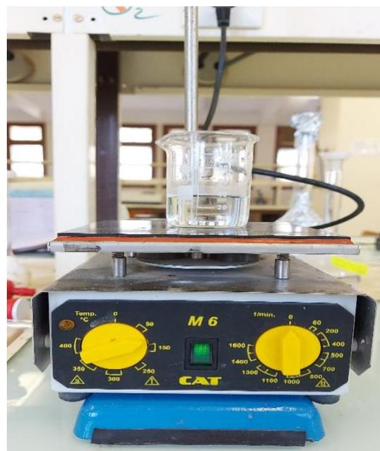
Figure 41agitateur magnétique
