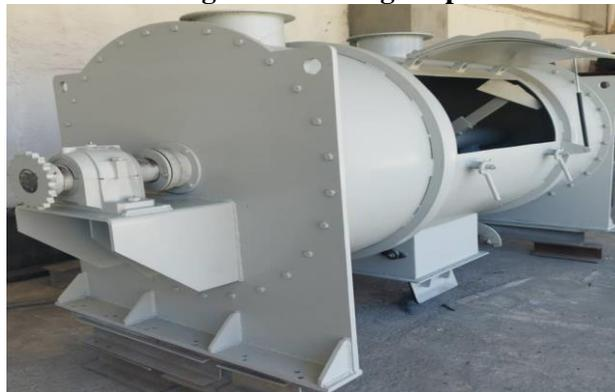
Figure 13.mélangeur à ruban horizontal
