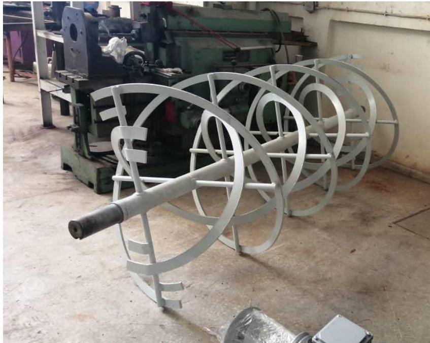
Figure 14.mélangeur hélicoïdal
