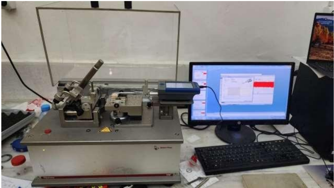
Figure3- 6 tribomètre type ANTON PAAR TRB3 CSM, switzerland équipé d'un profilomètre 2D
