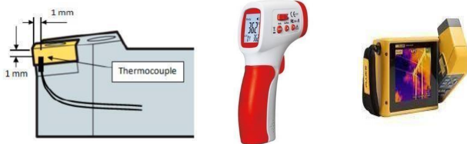
Figure II.7: Dispositifs de mesure de la température lors de l'usinage : thermocouple, pyromètre, et caméra infrarouge
