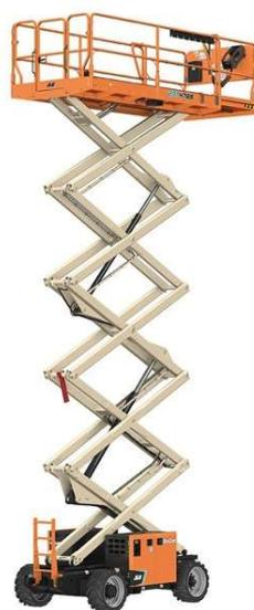
**Figure 15 :** Plateformes élévatrices à ciseaux
