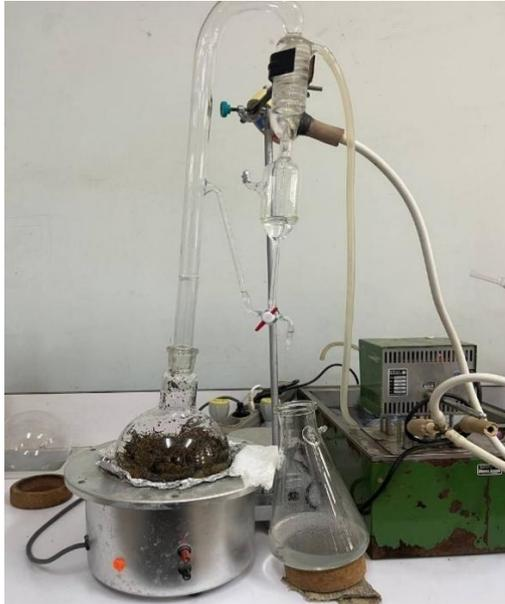
**Figure 01 :** Un appareil de distillation de type Clevenger.
