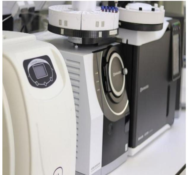
**Figure 02 :** Chromatographie Gazeuse/Spectrométrie de Masse
