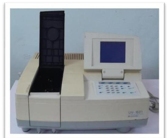
**Figure 05 :** Un spectrophotomètre UV-Vis
