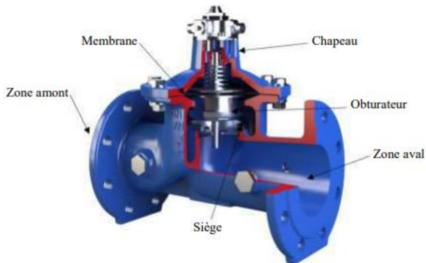
Figure 2.8: Les éléments de la vanne principale à membrane
