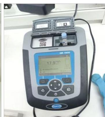
Figure 35. Matériel utilisé pour déterminer la DCO
