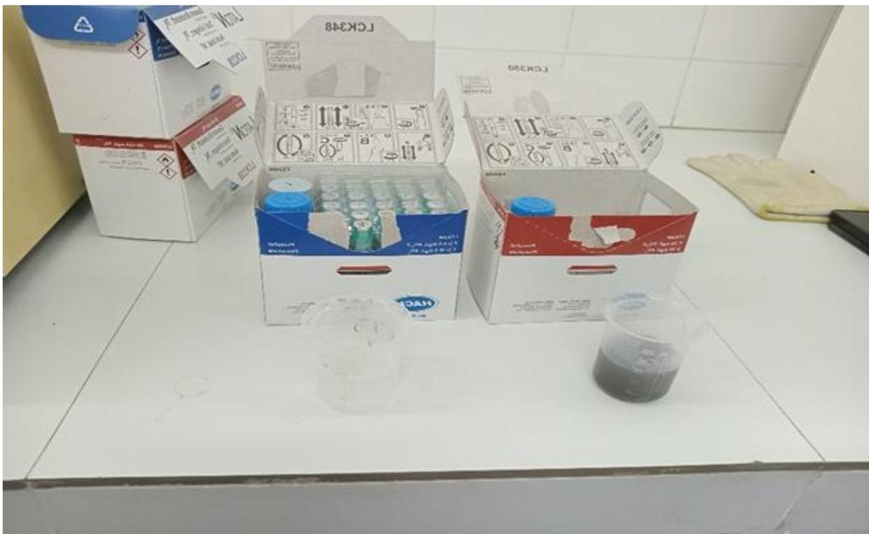
Figure 37 . Kits de dosage pour mesurer le phosphate
