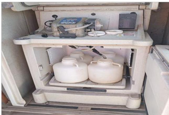
**Figure 32. Echantillonneur**
