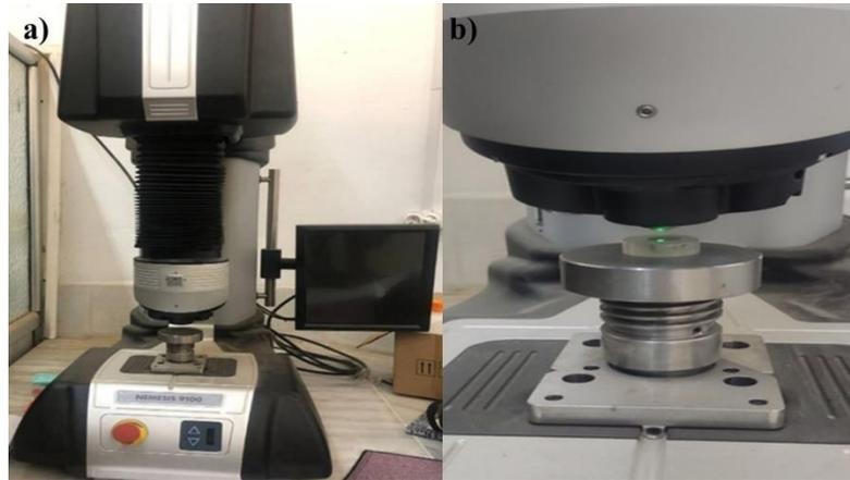
**Figure 3.26 :**(a) NEMESIS 9100 Duromètre "INNOVATEST " utilisé, (b) Gros plan sur le test de dureté.
