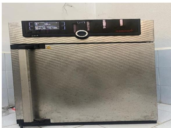
**Figure 3.3:** Étuve de laboratoire de recherche études et recherche en technologies industriels département mécanique université blida 1.
