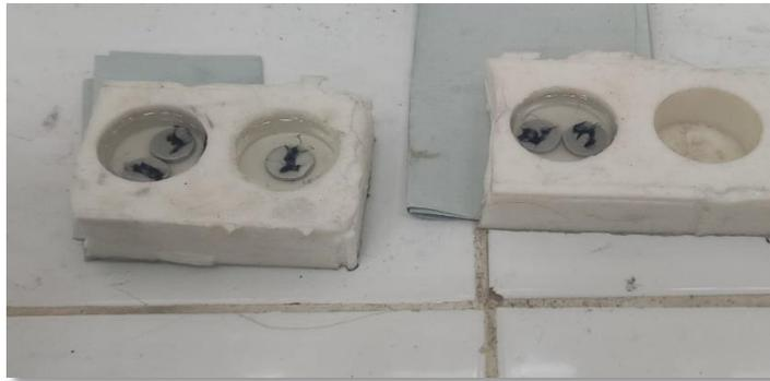
**Figure 3.22:** L'enrobage des échantillons.
