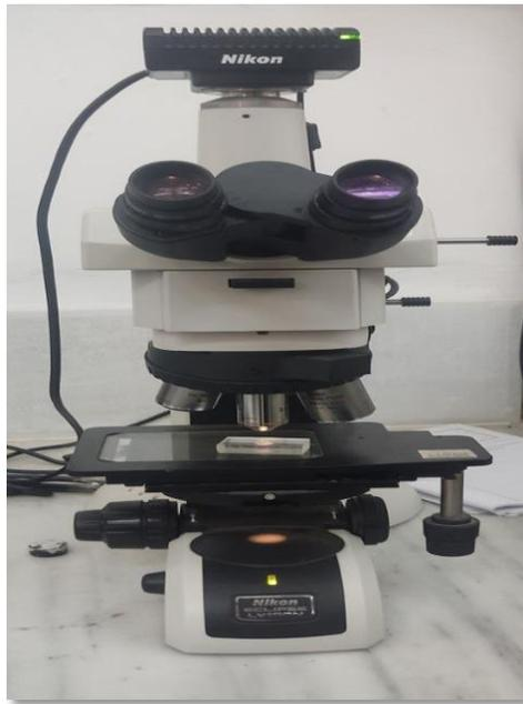
**Figure 3.25 :** Microscope optique" Nikon Eclipse LV150N "utilisé.
