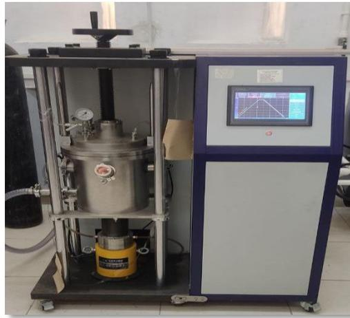
**Figure 3.18:** La machine de frittage (HP) utilisée de (laboratoire études et recherche en technologie industrielle).
