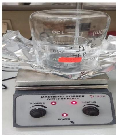
**Figure 3.15** : Mélange des poudres avec un agitateur magnétique.
