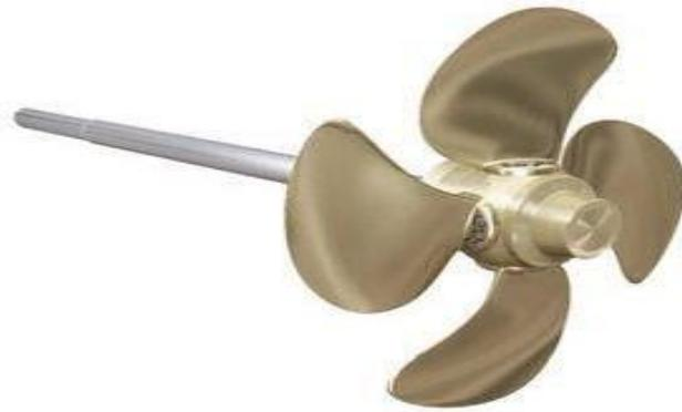
**Fig.1.4: Hélice à pales orientables. [16]**
