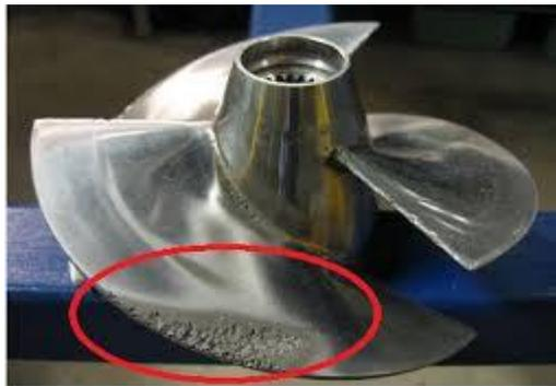
Fig.3.8: Début d'érosion d'une pale d'hélice marine. [9]
