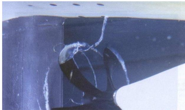
**Fig.3.7: Cavitation de tourbillon de coque [7]**
