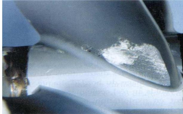
**Fig.3.5: Cavitation à poche partielle [7]**
