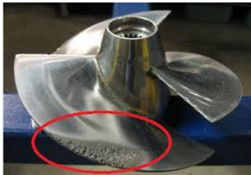
Fig.3.8: Début d'érosion d'une pale d'hélice marine. [9]
