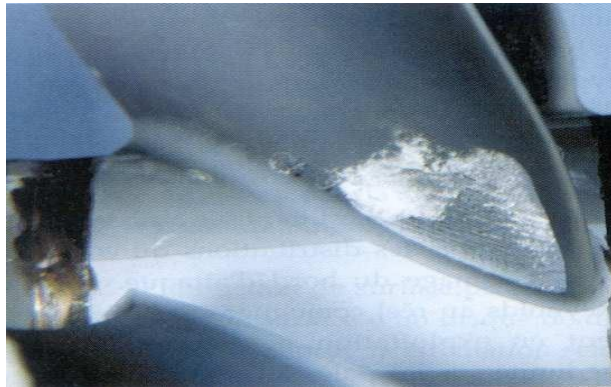
Fig.3.5: Cavitation à poche partielle [7]
