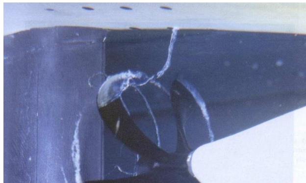
Fig.3.7: Cavitation de tourbillon de coque [7]
