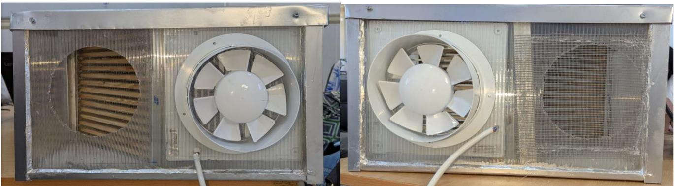
**Figure 24: Vue finale de l'échangeur assemblé et fermé**
