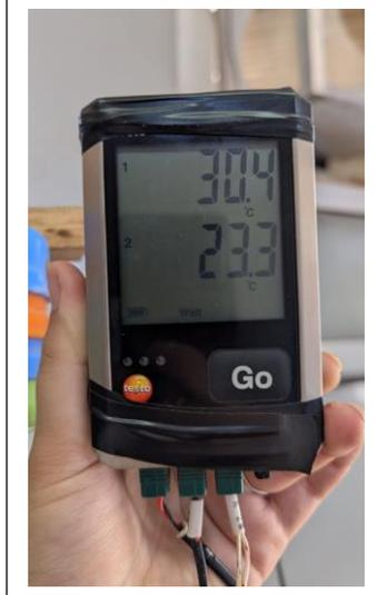
**Figure32 : Datalogger Testo affichant les températures en temps réel**
