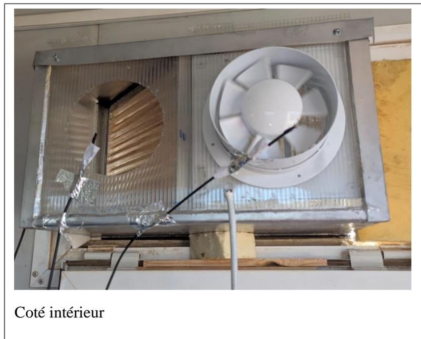
**Figure33 : Positionnement des thermocouples sur l'échangeur**
