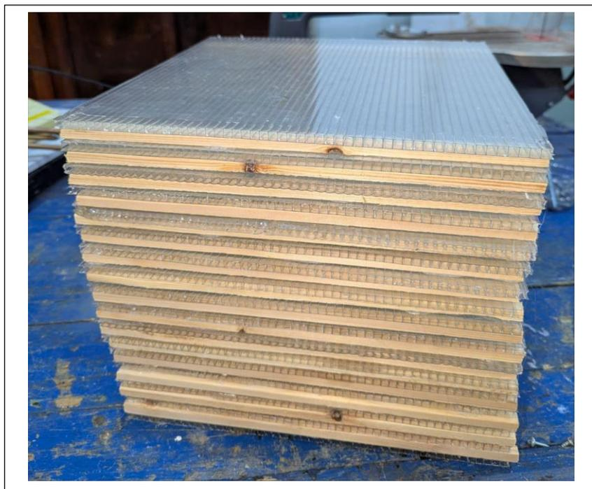
**Figure 21 : Vue de la plaque côté tubes (53 tubes de 6×5 mm)**
