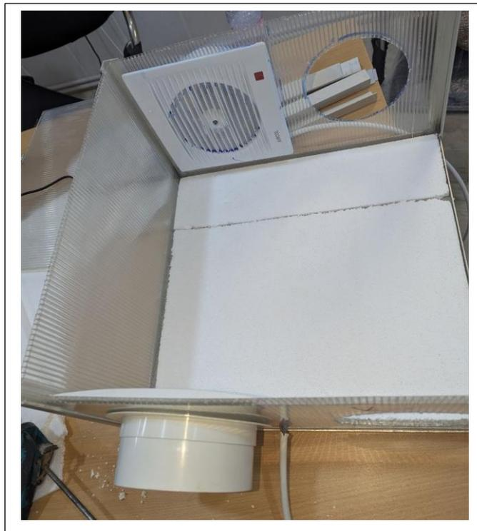
**Figure 23: Boîtier de l'échangeur avec ouvertures latérales**
