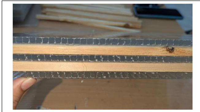
**Figure 18: Vue de la plaque côté tubes – 53 tubes (5 × 6 mm)**
