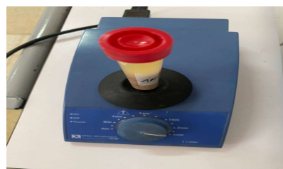
Figure 08 : Agiter le tube à essai contenant le
