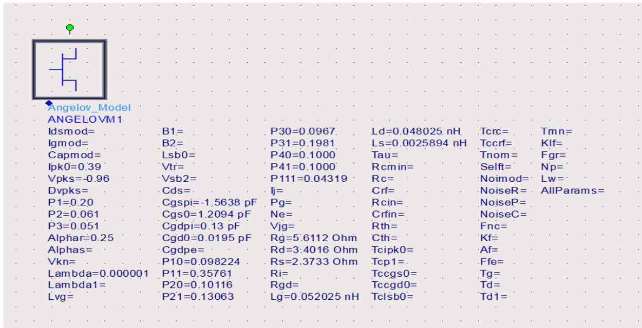
Figure 3.3 : représenté Le transistor d'Angelov sur ADS avec les paramètres optimisés à V_{gs} = -3,5 V, V_{ds} = 30 V.
