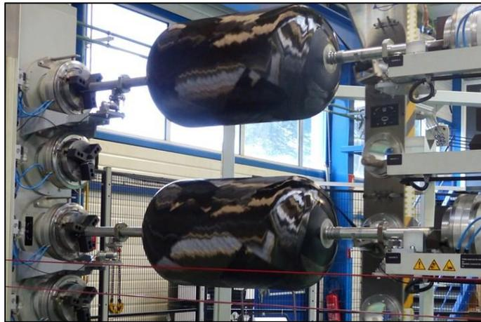
Figure 2.8 Réservoir cryogénique multiple en carbone pour applications hydrogène aéronautique [21]
