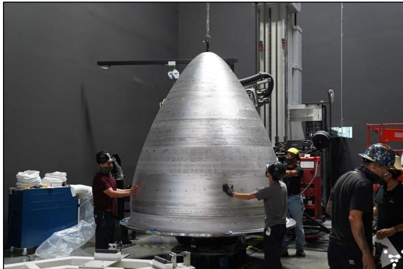
Figure 2.7 Réservoir conique imprimé 3D en test [22]
