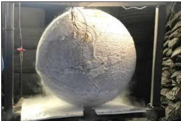
Figure 2.5 un réservoir cryogénique sphérique entièrement composite sans doublure [21]
