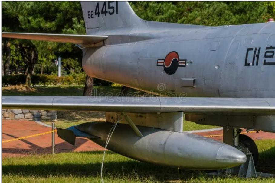
Figure 2.13 Réservoirs De Carburant Externes à L'aile Du Jet Militaire [22]
