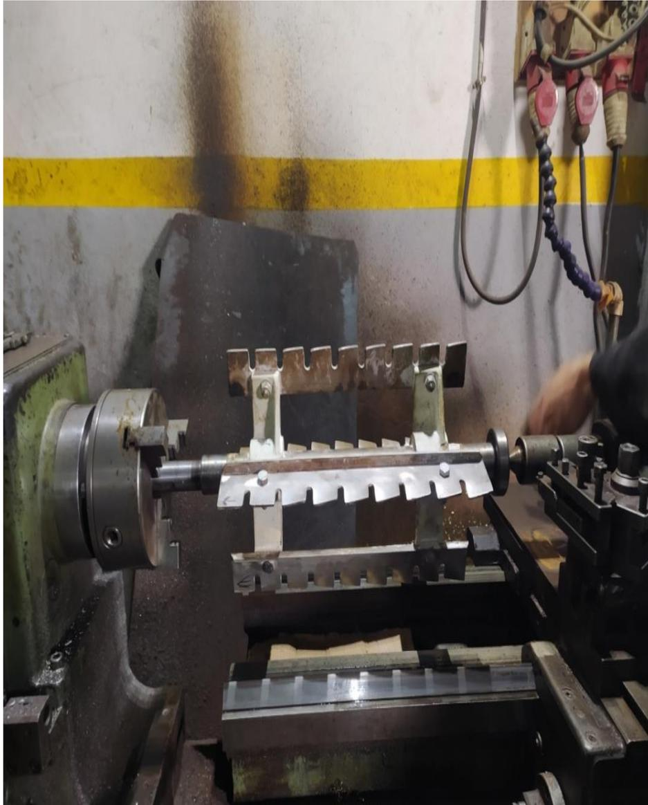
Photo 4-4 : Contrôle des portées de roulement et déformation du rotor détacheur DS 306
