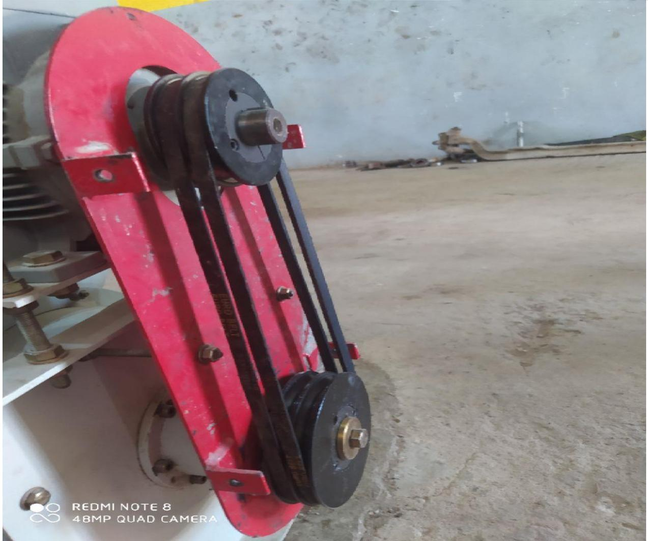
Photo4-3 : Roulement et courroie de transmission du détacheur
