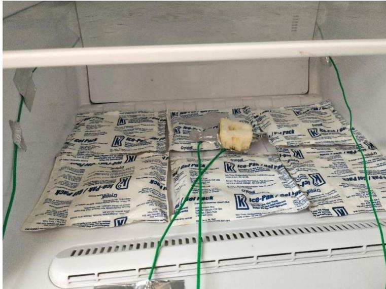
Figure 39. Emplacement des matériaux à changement de phase (PCM) à l'intérieur du congélateur
