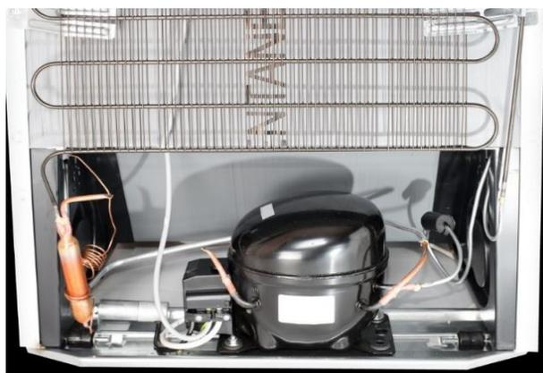
Figure 34. Compresseur du réfrigérateur.
