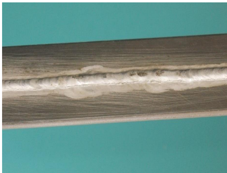
Figure 1.10 : Apparition d'une fissure lors du soudage TIG d'un alliage d'aluminium 7075 T6 (épaisseur = 2 mm)
