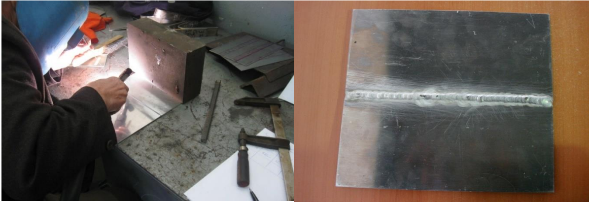
Figure 3.7 : Plaques soudées (épaisseur = 2.5 mm)
