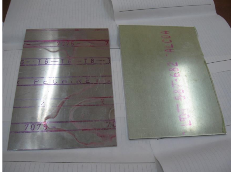
Figure 3.1 : Plaque brute d'aluminium 7075 T6 (épaisseur = 2 mm)
