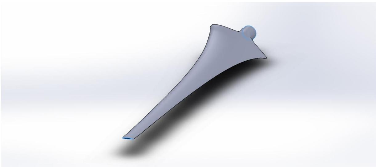
**Etape 5** : Transformer la surface en corps uni avec la fonction « surface cousue »
