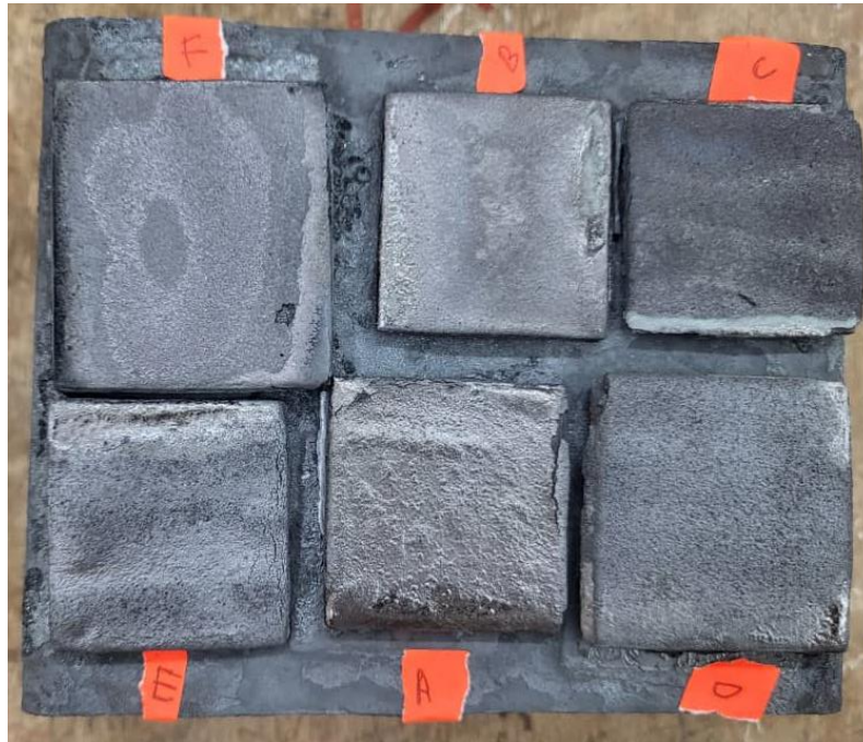
Figure 3.12 : Aspects des revêtements traités thermiquement à leur sortie du four à moufle.
