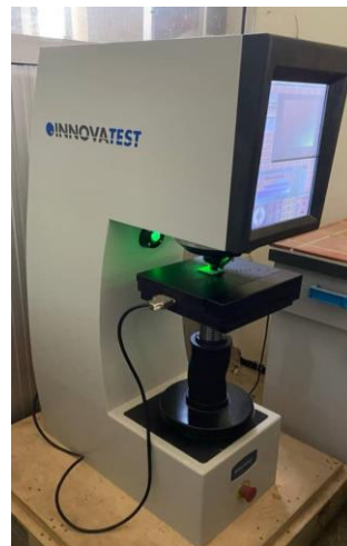
Figure 2.16 : L'échantillon lors de l'essai de la dureté.
