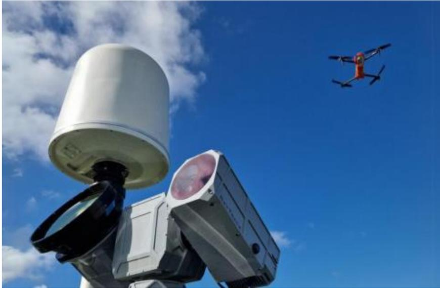
Figure 1.11: système de détection de drones par RADAR
