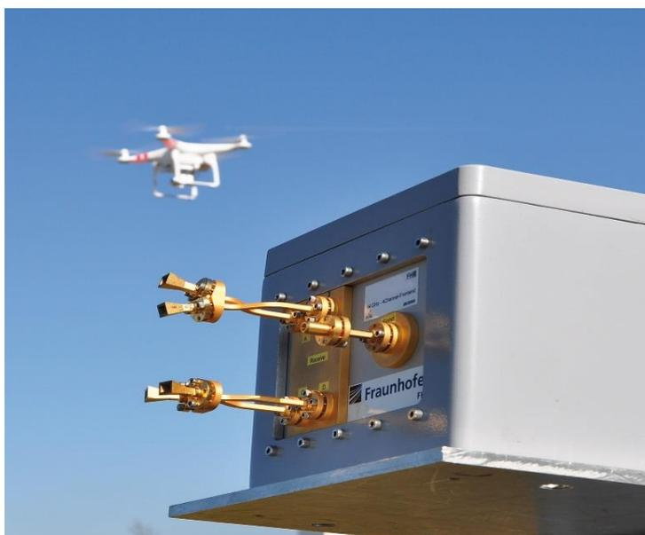
Figure 1.12: système de détection de drones Radio Fréquence [34]
