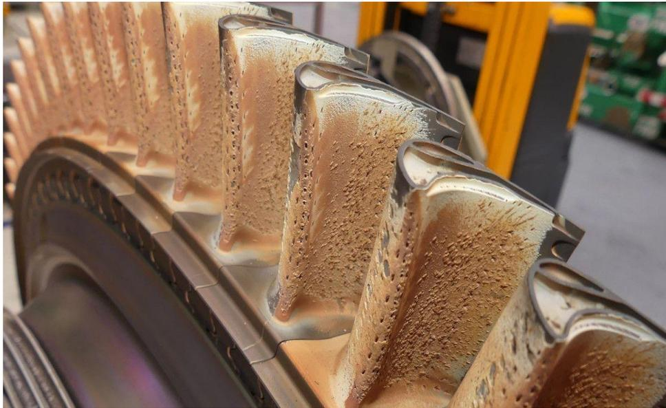
**Figure 3.3:** Effets visibles de l'exposition au sable sur un moteur d'avion
