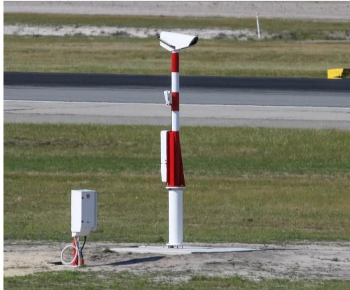
**Figure 1.4:** Le transmissiomètre
