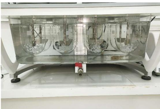
**Figure 2.7 :** Dissolution des billes dans le milieu 1,2.
