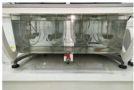
**Figure 2.8 :** Dissolution des billes dans le milieu 6,8.
