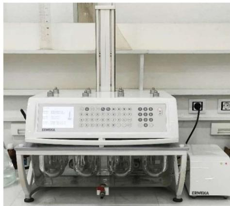
**Figure 2.6 :** Dissolu test à palettes tournantes.
