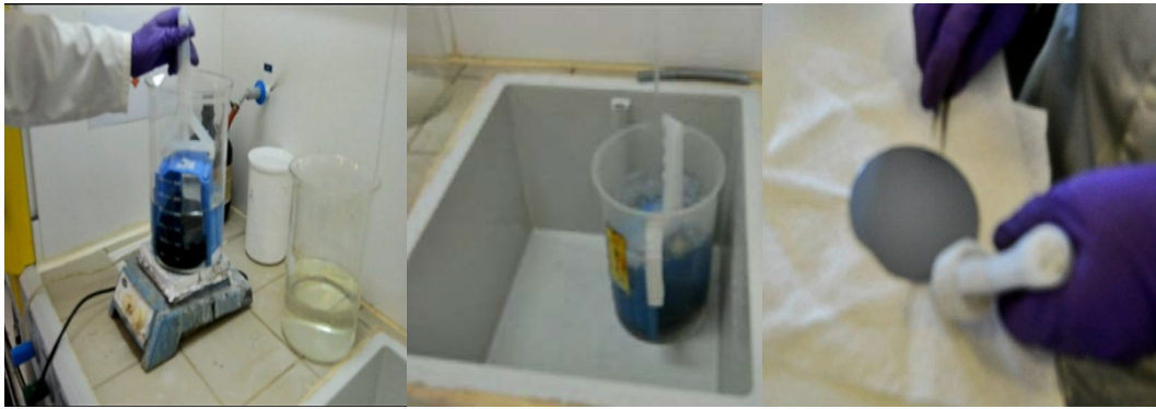
Figure II.2 : A/ oxydation et désoxydation des plaquettes par des solutions différentes. B/ rinçage à l'eau abondant. C/ séchage avec l'azote.
