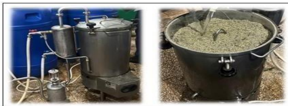
Figure 2.2 : Schéma du procédé d'hydrodistillation pour l'extraction de l'huile essentielle de Rosmarinus officinalis , ( Bakkali et al. 2008).
