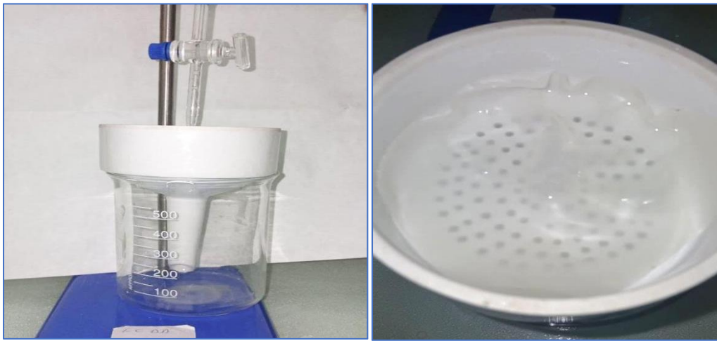
Figure III.12 : Montage expérimental du test de perméabilité à l'eau du bioplastique
