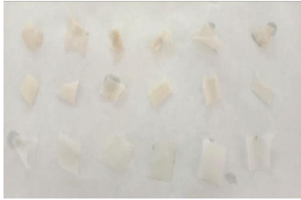
Figure III.10 : des échantillons de bioplastique après 24 h d'immersion dans des milieux acides et basiques
