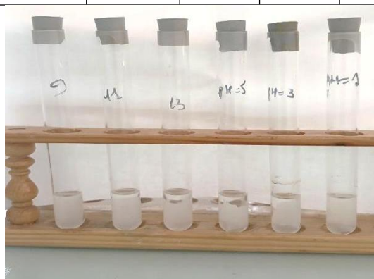
Figure III.9 : Échantillons de bioplastique immergés dans des milieux acides et basiques de différents pH
