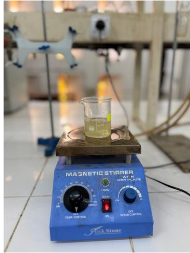
Figure 1.9 : Agitation d'un mélange chitosane et MMT
