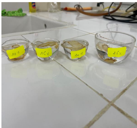
Figure 2.1 : Échantillons de membranes en cours de gonflement
