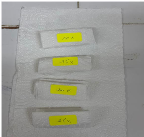
Figure 2.2 : Échantillons de membranes en cours de séchage après gonflement
