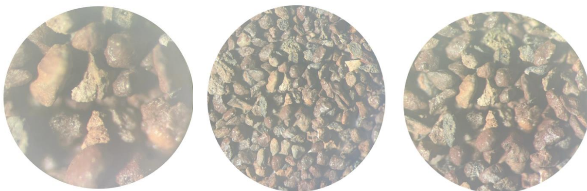
Figure II.12. Observation microscopique des grains d'argile expansée de diamètre 0,63–0,8 mm sous microscope optique
