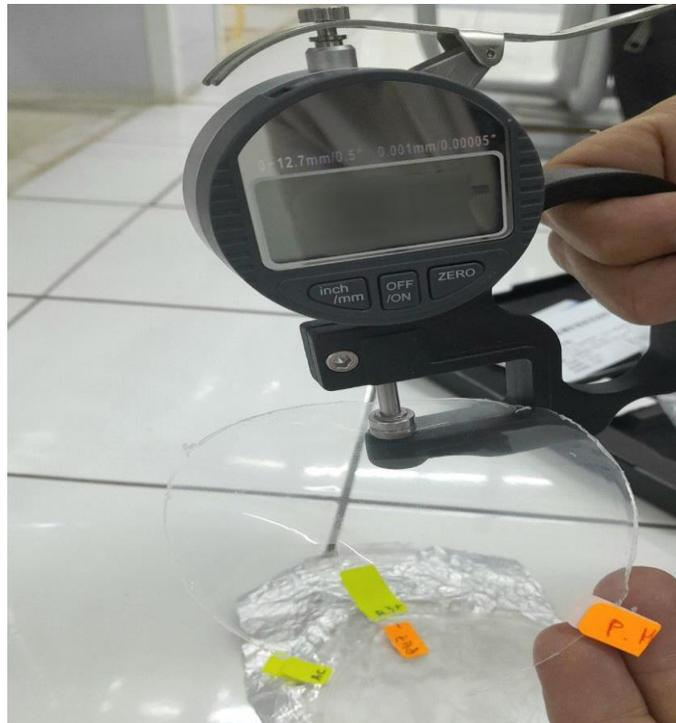
Figure III. 10. Micromètre digit
