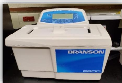
**Figure III. 5. Appareil d'ultrasonication (BRANSON 2800).**
