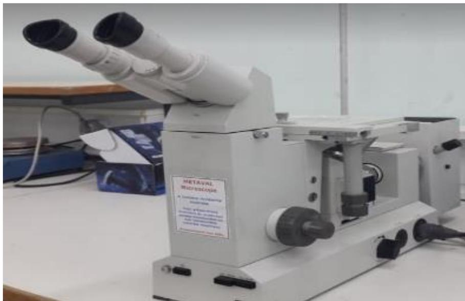
**Figure III. 9. Microscope METAVAL à lumière incidente inversée**
