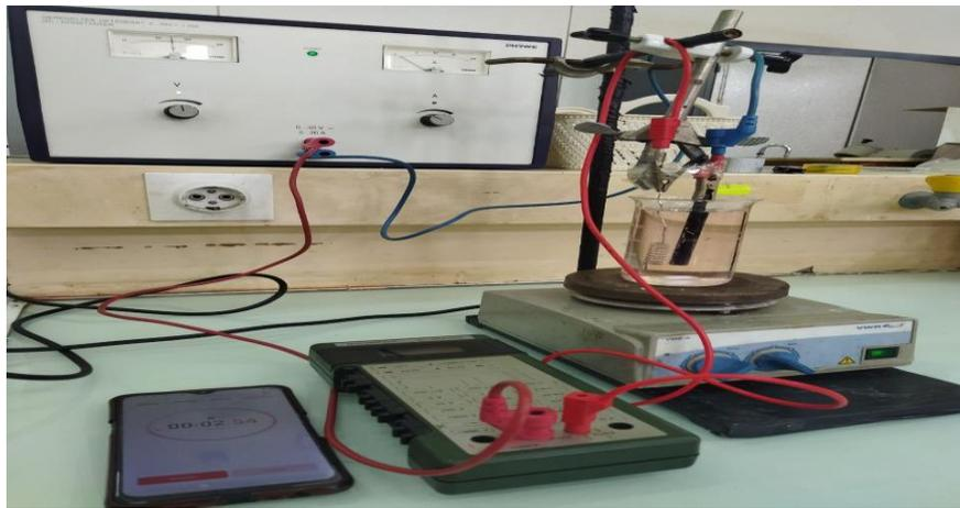
**Figure 2.7 :** Montage de l'électrodéposition d'électrode de travail en GF par le cobalt.
