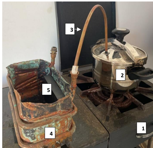
Figure 3.32. Montage de distillation N°6 équipé d'un serpentín rectangulaire en cuivre corrodé exposé à un champ magnétique. 1 Réchaud à gaz, 2 Cocotte, 3 Tuyau en cuivre, 4 Serpentín en cuivre corrodé, 5 Aimant rectangulaire (15 cm × 10 cm, 117 mT)
