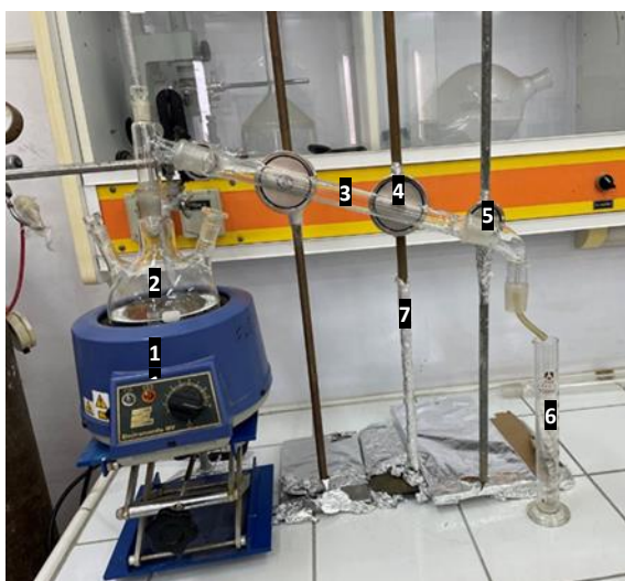
Figure 3.2. Montage de distillation N°1 soumis à un champ magnétique. 1 Chauffe-ballon électrique, 2 Ballon à fond rond, 3 Colonne de distillation, 4 Aimant circulaire ( \varnothing 7,5 cm, 229 mT), 5 Aimant circulaire ( \varnothing 5 cm, 119 mT), 6 Éprouvette graduée (100 mL), 7 Support
