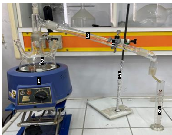
Figure 3.1. Montage de distillation N°1. 1 Chauffe-ballon électrique, 2 Ballon à fond rond, 3 Colonne de distillation, 4 Pince, 5 Support, 6 Éprouvette graduée (100 mL)
