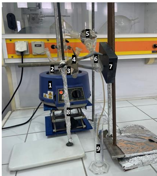
Figure 3.4. Montage de distillation N°2 soumis à un champ magnétique. 1 Chauffe-ballon électrique, 2 Ballon à fond rond, 3 Aimant circulaire ( \varnothing 6 cm, 220 mT), 4 Pince, 5 Aimant circulaire ( \varnothing 7,5 cm, 229 mT), 6 Colonne graduée, 7 Aimant rectangulaire (15 cm \times 10 cm, 117 mT), 8 Support, 9 Éprouvette graduée (50 mL)
