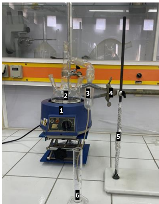
Figure 3.3. Montage de distillation N°2. 1 Chauffe-ballon électrique, 2 Ballon à fond rond, 3 Colonne graduée, 4 Pince, 5 Support, 6 Éprouvette graduée (50 mL)
