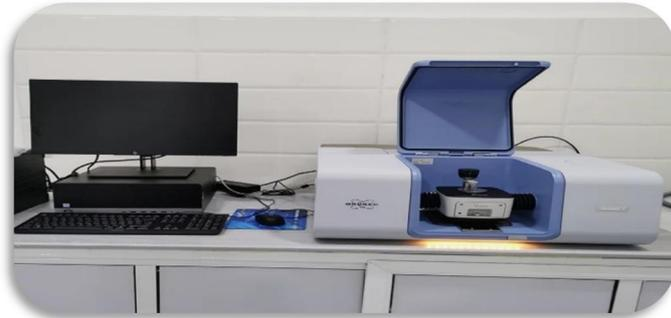
**Figure II.4:** Spectromètre Infrarouge FTIR.
