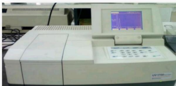
**Figure II.3:** le spectrophotomètre UV-visible
