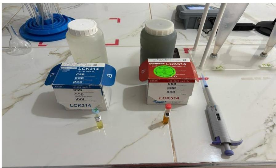
**Figure 2.7** : détermination de la DCO par kit LCK
