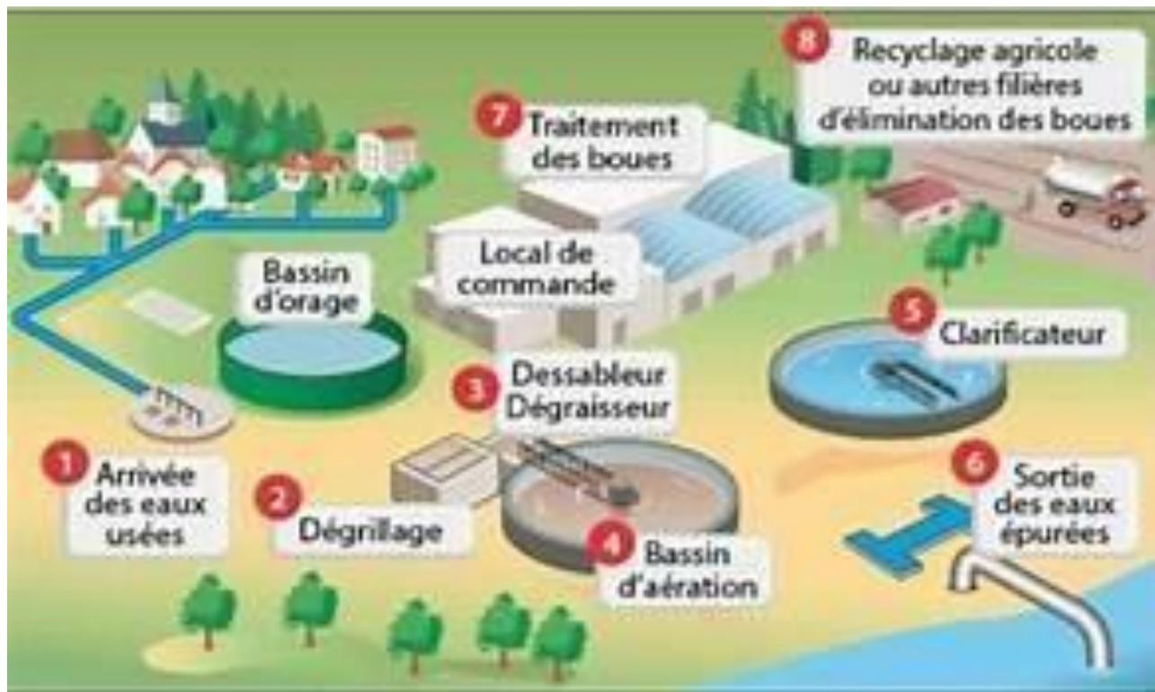
Figure 1. 3 : schéma de fonctionnement d'une station d'épuration
