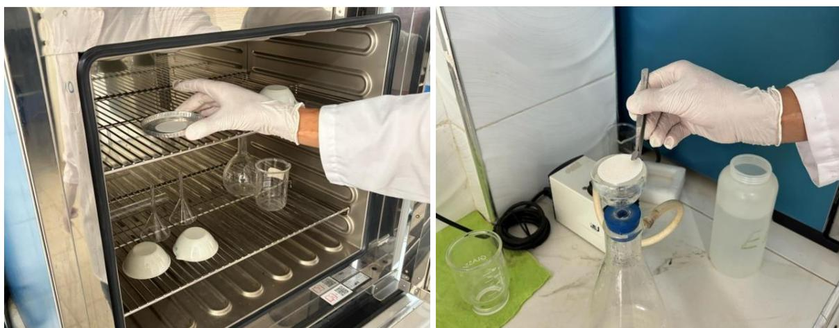
**Figure 2.5** : détermination de MES par la technique de filtration
