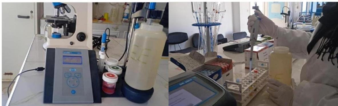
**Figure 2.2 :** analyse du pH par pH-mètre HACH sensION
