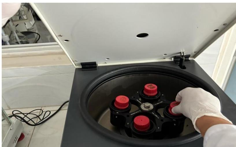
**Figure 2.6** : détermination de MES par la technique de centrifugation
