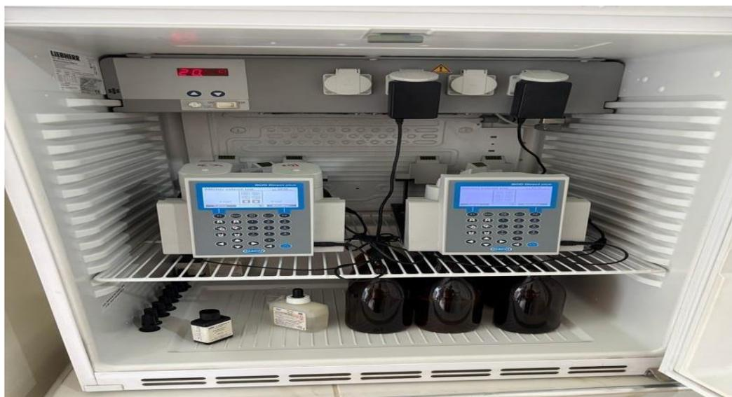
**Figure 2.8** : Détermination de la DBO<sub>5</sub> par le DBO mètre
