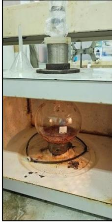
**Figure II.1 :** Réacteur micro-ondes.
