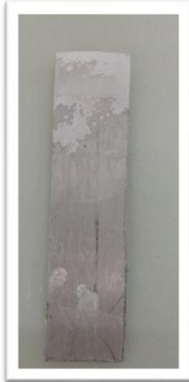
**Figure II.9** : Les électrodes d'aluminium 2024.
