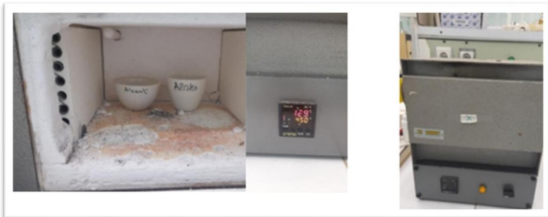
**Figure II.4 :** Four de test de cendre et les échantillons dans les creusés.
