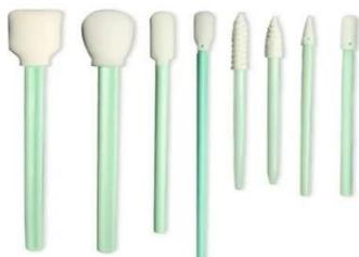
Figure V.13 Différents types d'écouvillons utilisés pour les prélèvements directs
