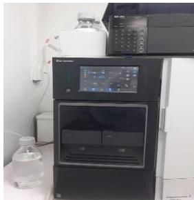
Figure IV.4 Chromatographe HPLC avec injecteur automatique
