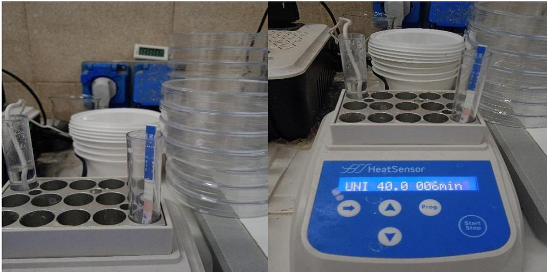
**Figure 4: Introduction de la bandelette dans le flacon et incubation à 40°C.**
