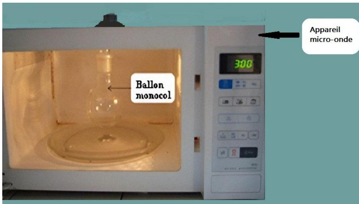
**Figure 2.2:** Micro-onde utilisé dans l'extraction du chitosane.
