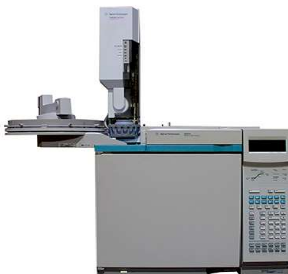
Figure II.9 : Chromatographie en phase gazeuse - Détecteur à ionisation de flamme (GC-FID).
