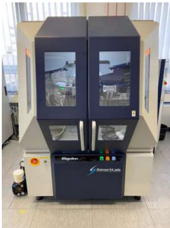
Figure II.11 : Diffractomètre à poudre Rigaku SmartLab.
