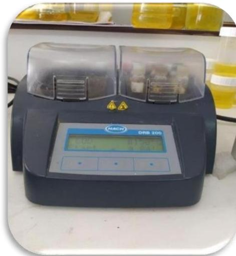
Figure II.9: Colorimètre de marque DRB 200 pour la mesure de la DCO.
