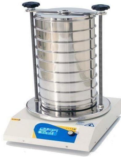
Figure II.4 : Tamiseur automatique de marque CISA modèle BA-200N.
