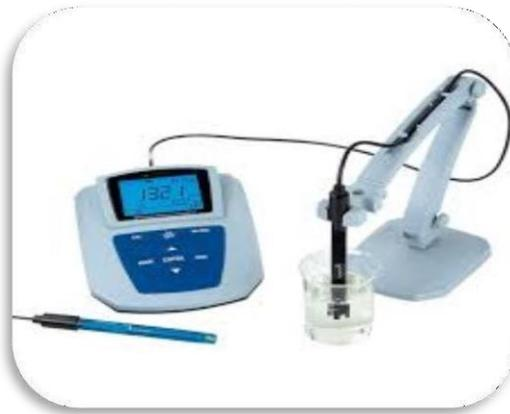
Figure II.5 : Multi paramètres pour la mesure du pH et de la conductivité.
