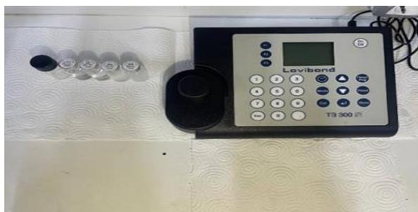
**Figure II-3:**Turbidimètre TB 300 IR
