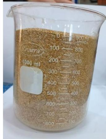
**Echantillon 2** : sable ( $d= 0.25\text{mm}$ )
