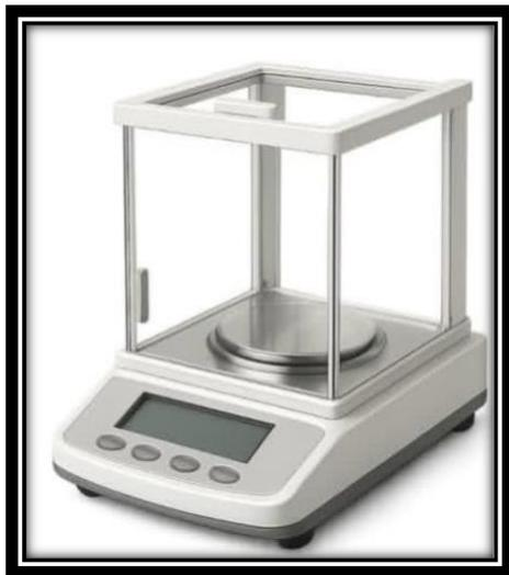
**Figure IV.8:** Balance analytique.
