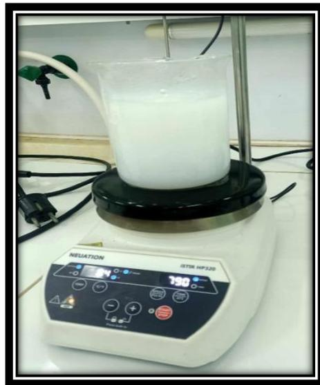
**Figure IV.9 :** la solution sol-gel de l'acétate de Zinc.
