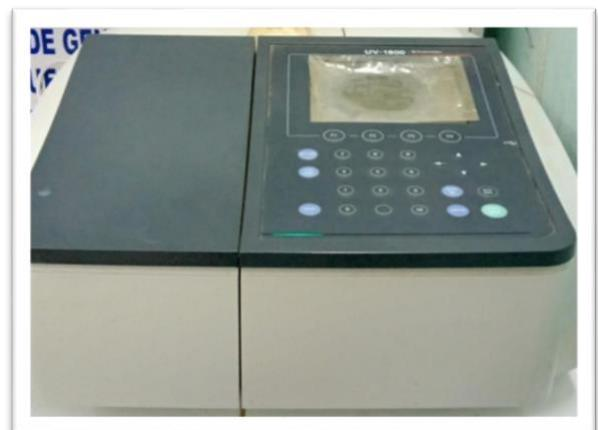
**Figure IV.11:** spectrophotomètres visible (Shimadzu).
