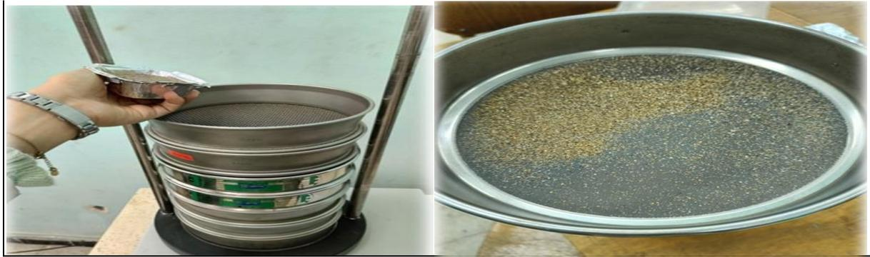
**Figure III .6** : photos numériques illustrant l'opération du tamisage des sédiments
