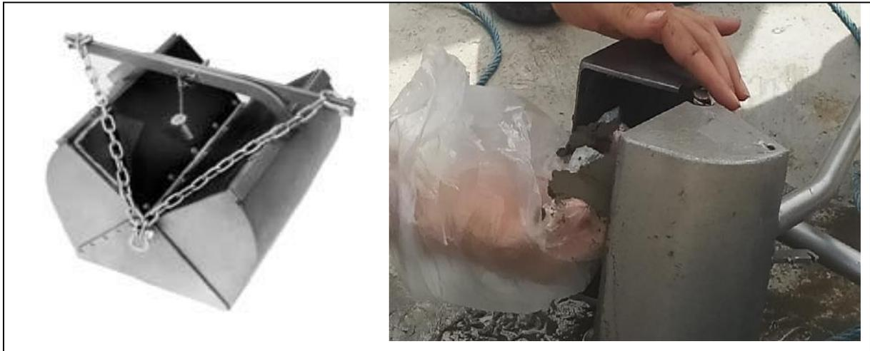
**Figure III.1:** photos numériques de Benne Van Veen utilisé pour le prélèvement des sédiments
