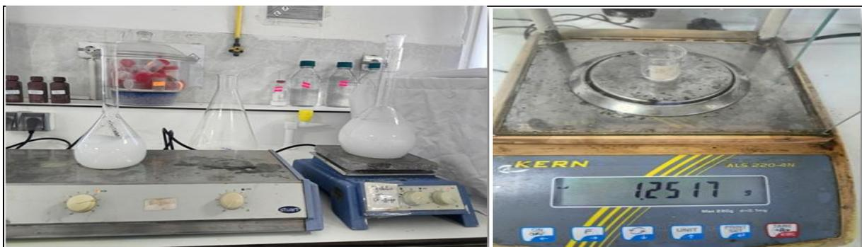
**Figure III.7** : préparation de la solution saturée en NaCl
