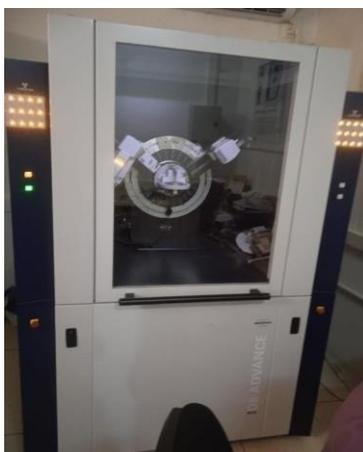
**Figure II. 11 : diffraction des rayons X (DRX)**
