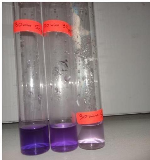
Figure III. 17 : Tubes de  $t=30\text{min}$  de concentration 50 PPM , 30 PPM et 5 PPM
