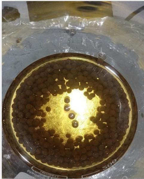
**Figure II. 6 : les billes dans la solution  $\text{CaCl}_2$**
