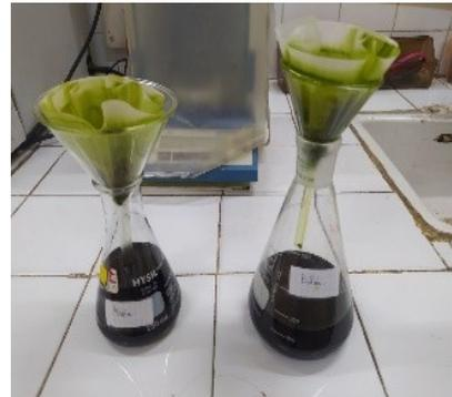
Figure 09 : Filtration du mélange hydro-éthanolique
