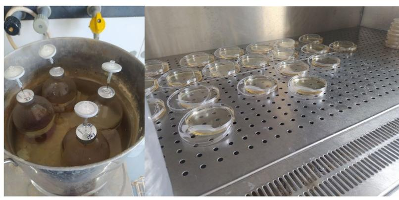
**Figure 14** : Coulage de gélose dans les boîtes de Pétri
