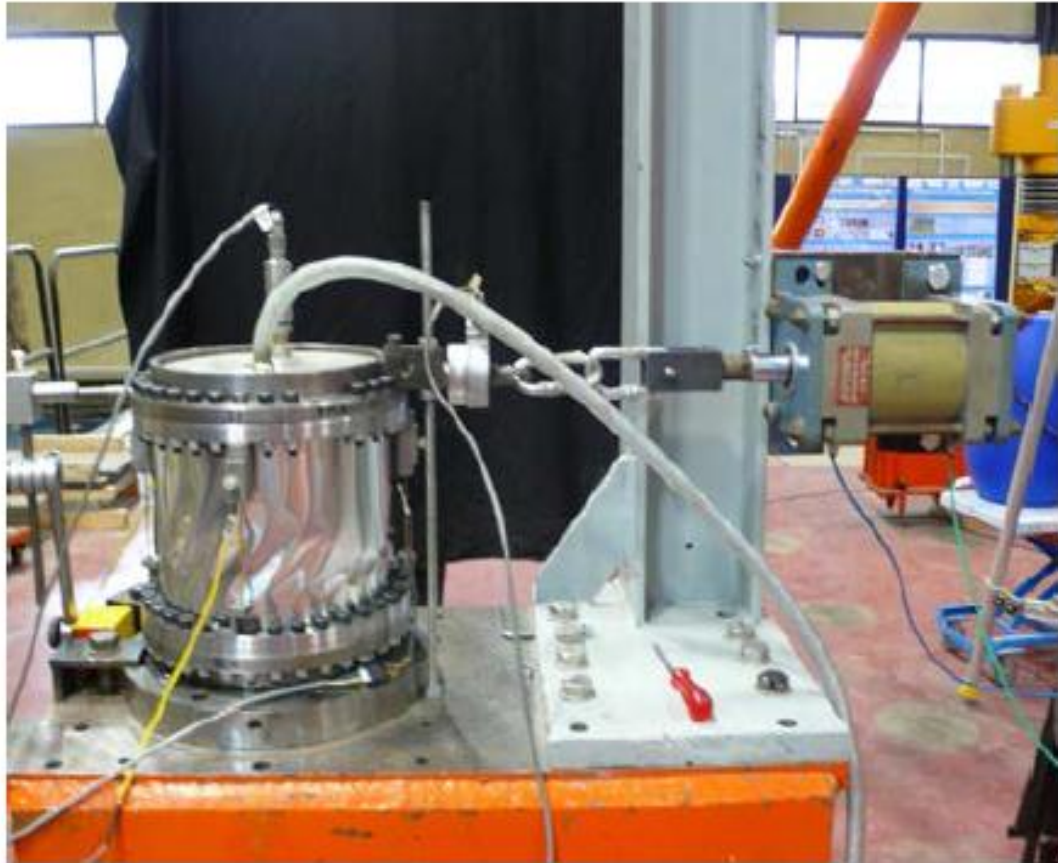
Figure 3. 2 : Photographie de l'outil d'électrodéposition et de la RCH in situ [67].
