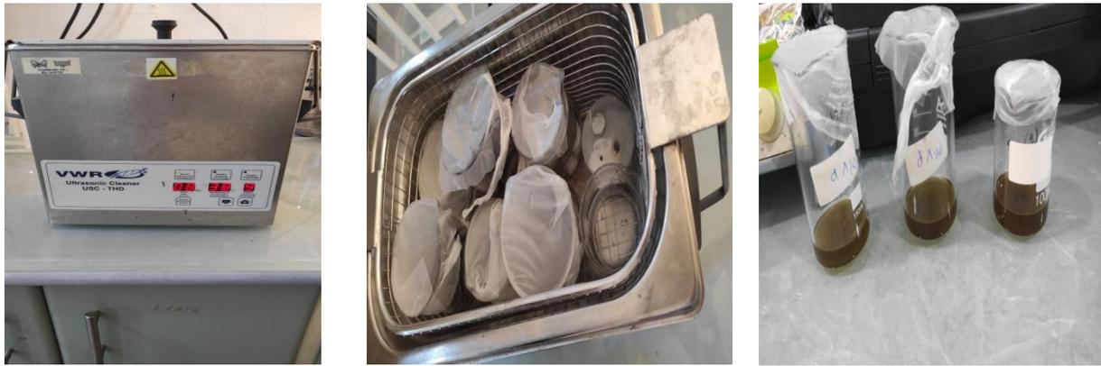
**Figure II.14** : Sonication des solutions membranaires et solution de l'oxyde de graphene
