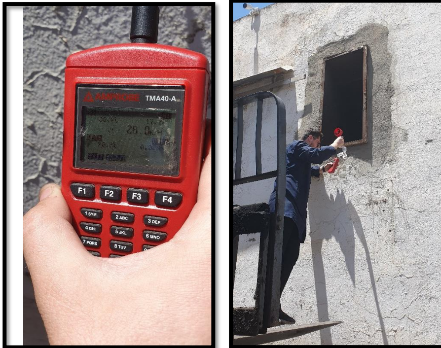
Figure 48: illustration lors de la mesure de la vitesse de l'air chaud. Source : auteur.
