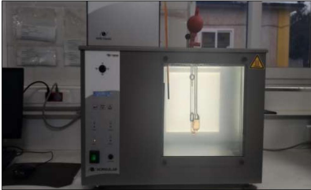
**Figure 2.8:** Bain thermostaté de viscosité à 40°C.
