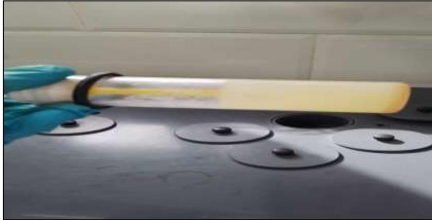
**Figure 2.10:** L'échantillon à la température de congélation.
