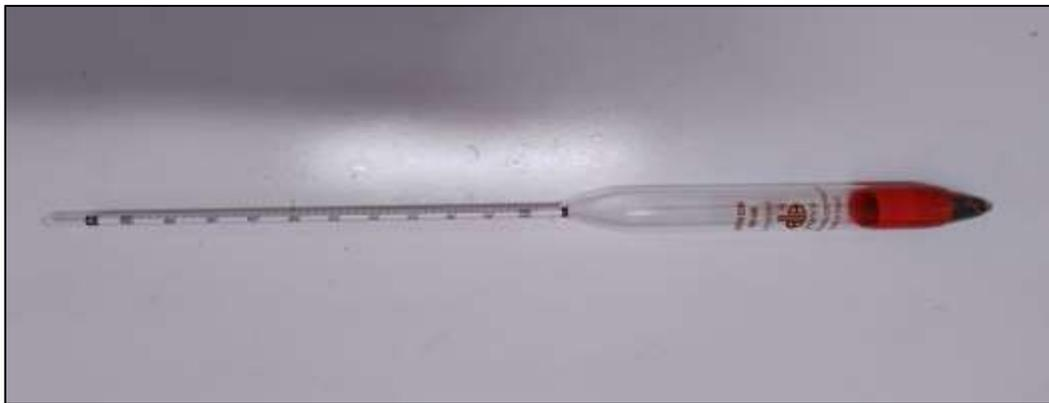
**Figure 2.3:** Aréomètre.
