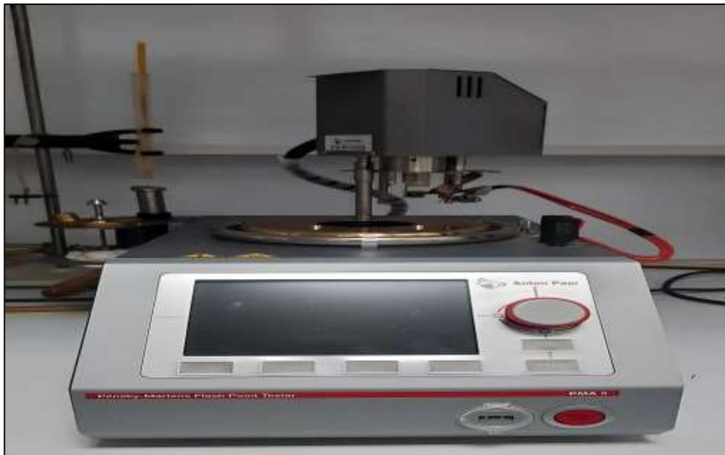
**Figure 2.5:** Appareil de mesure de point éclair (vase fermé).
