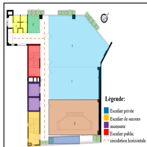
Figure68 : Plan de 6ème étage Source : archdaily, figure traitée par l'auteur
